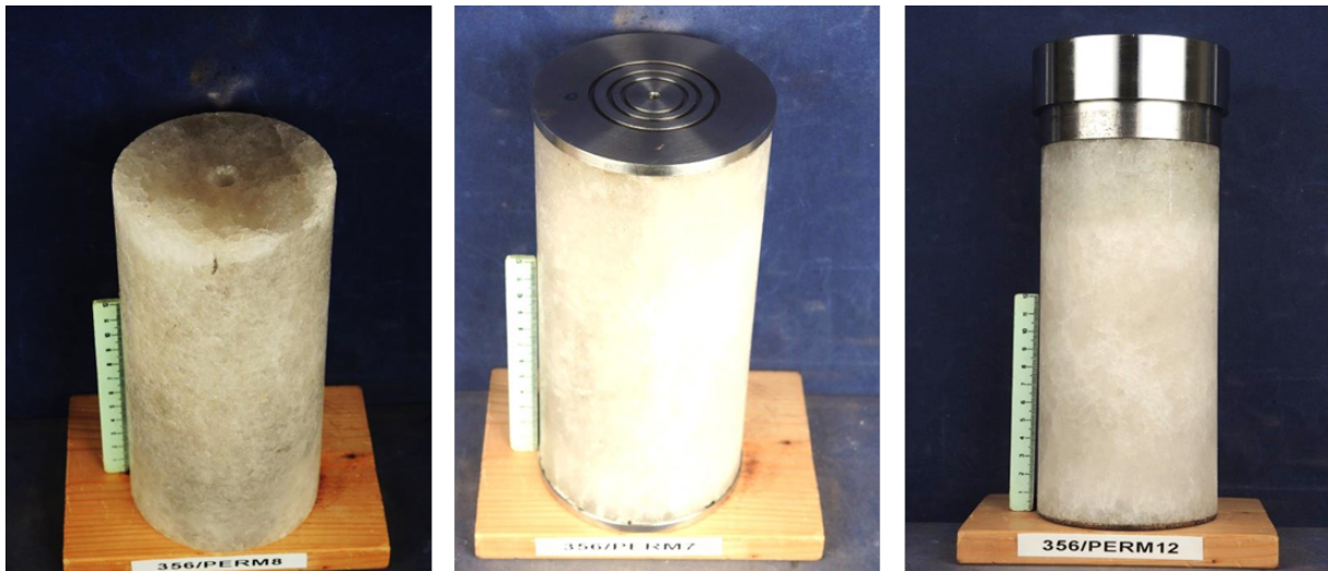
Abb. 45: Beispiele für fertig präparierte Steinsalzzylinder mit zentraler Sackbohrung (links), aufgesetzter Stempelplatte für axiale Durchströmung (mittig) sowie aufgesetzter Stempelplatte und Sinterscheibe für radiale Durchströmungsversuche (rechtes Bild).
