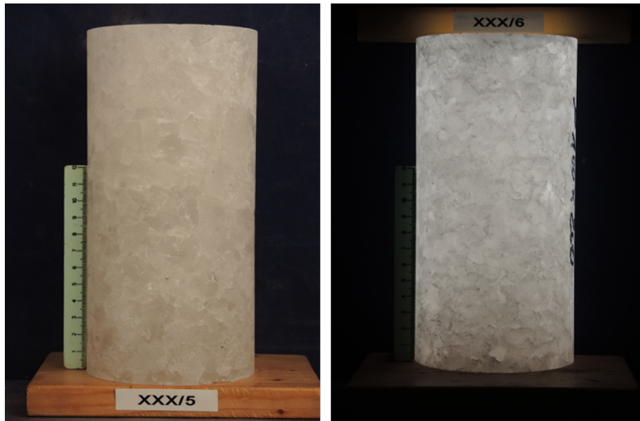
Abb. 43: Auflichtaufnahme (links) von Asse-Speisesalz (Probe xxx/5; Versuch 2) bzw. Durchlichtaufnahme (rechts) der Probe xxx/6 (Versuch 8).
