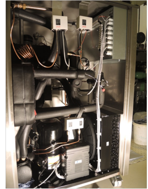
Heizaggregat zum Erhitzen des Silikon-Thermo-Öl für die zu realisierenden Versuchstemperaturen
