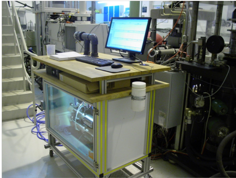
QUIZIX-Spindelpumpensystem zur Realisierung des Aufbringens von hohen Fluiddrücken und geringen (kontinuierlichen) Förderraten
