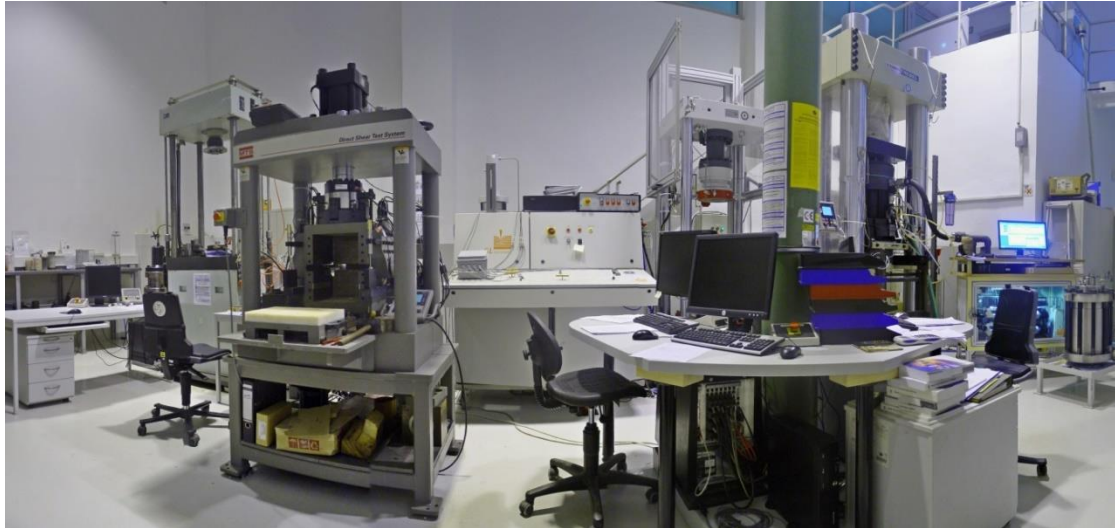
Abb. 46: Blick in das Prüflabor des IfG Leipzig mit den servohydraulischen Prüfmaschinen.
