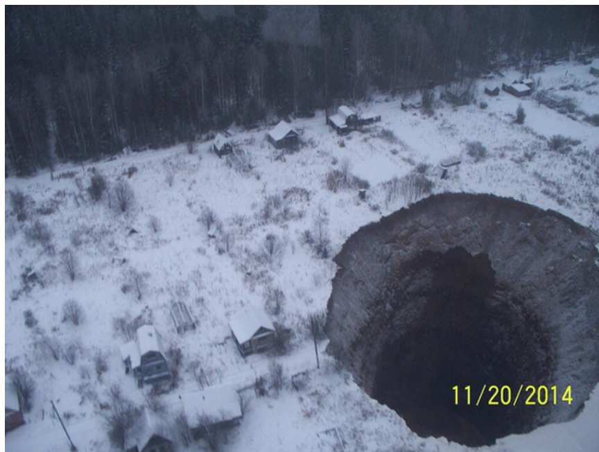
Abb. 27: Erdfall über der südlichen Bruchfeldkante (siehe Abbildung 26) der Grube Solikamsk II am 20.11.2014 (Minkley et al. 2016a)
