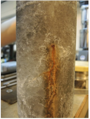
Probe nach Versuch mit punktuellm Austritt des Markers
