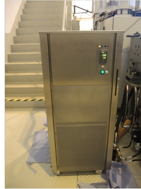
Heizaggregat zum Erhitzen des Silikon-Thermo-Öl für die zu realisierenden Versuchstemperaturen
