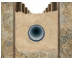
offene Verlegung im Sandbett
