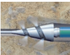
Black-Box-Verlegung wie Spülbohrung
