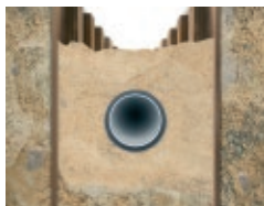
offene Verlegung im Sandbett
