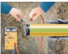
Nachweis auf beschädigungsfreien Einbau nach Verlegung
