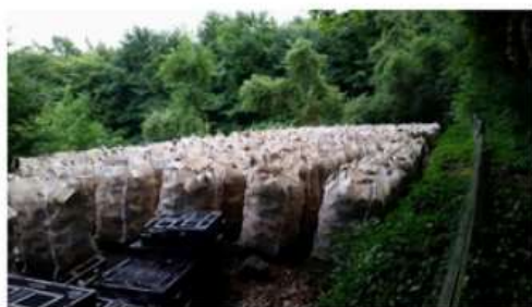
Die Anlieferung erfolgt in Woodbags (1,5 srm)
